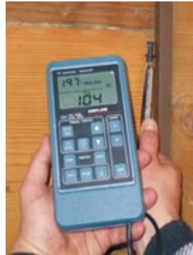
Abb. 14 Verwendung eines Luftgeschwindigkeitsmessgerätes
