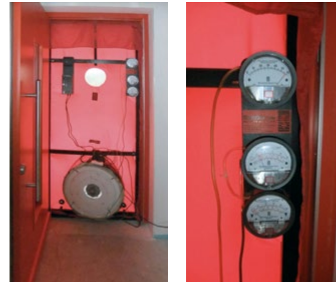
Abb. 11 / 12 Einbausituation Luftdichtheitsmessgerät im Türrahmen
