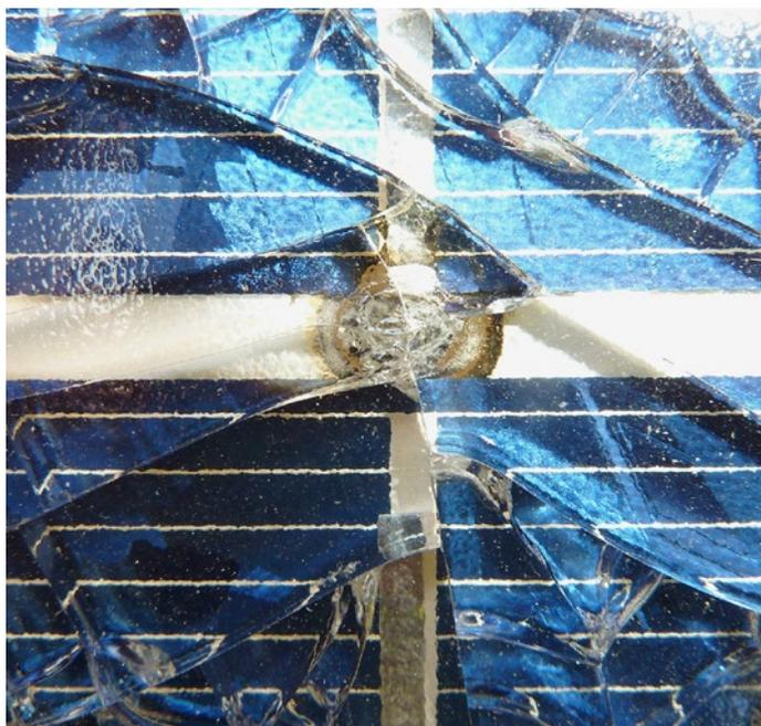
Abbildung 114: Blitzschaden an einem Solarmodul
