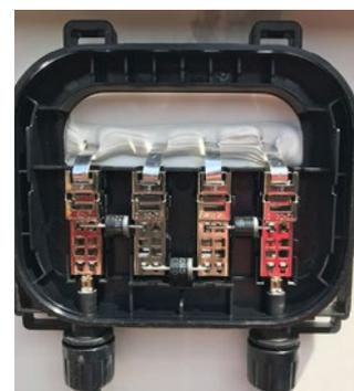
Abbildung 13: Aufbau einer Modul-Anschlussdose mit Bypass-Dioden
