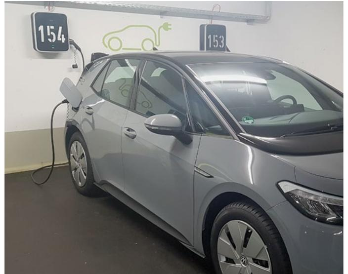
Abbildung 101: Laden eines E-Autos an einer Wallbox
