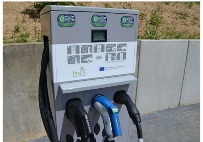
Abbildung 102: Schnellladestation mit verschiedenen Ladesystemen
