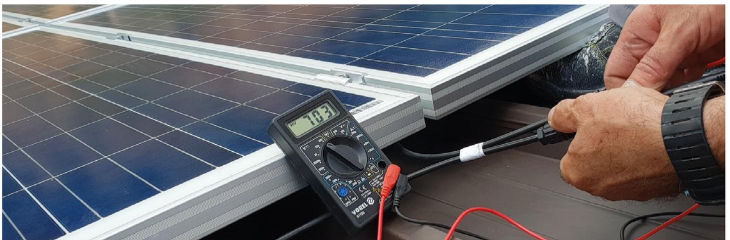
Abbildung 115: Funktionstest von Solarmodulen
