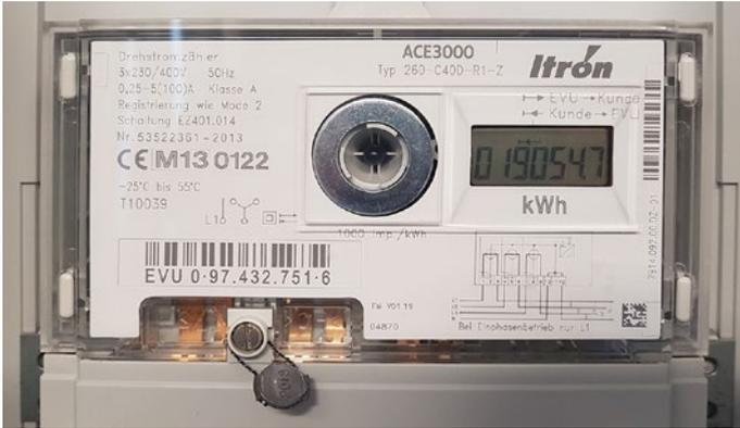
Abbildung 27: Digitaler Zweirichtungszähler
