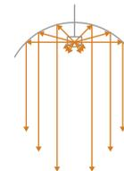
Kombination von sphärischem und parabolischem Reflektor
