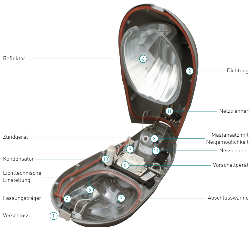
Abb. 08. Schnittzeichnung konventionelle Leuchte. [4]
