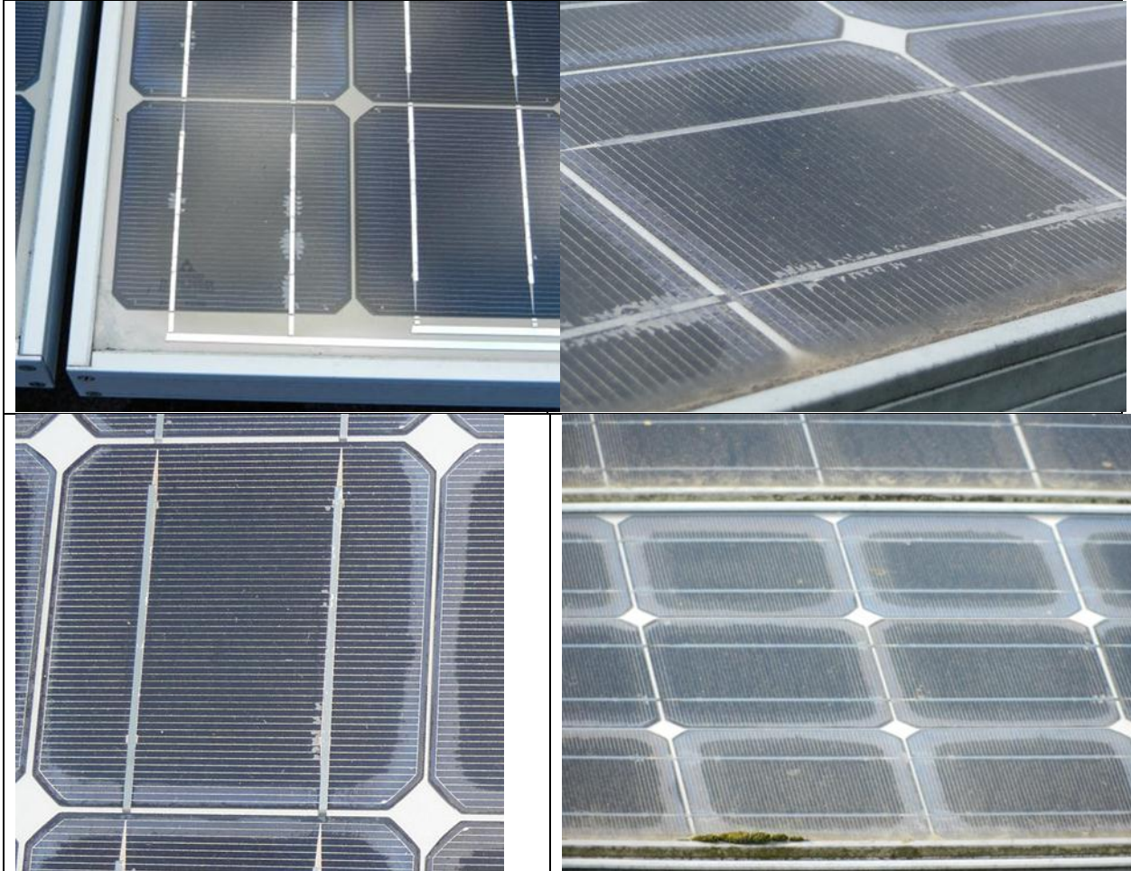
Bild 12: Typische Veränderungen der Solarzellen in Siemens M55 Modulen: oben und unten links: Delamination in der Umgebung der Stromsammelleitungen (PVA Chemnitz, PVA Rochlitz, PVA Freital I). Oben rechts und unten: Auflösung der Antireflexschicht (unten rechts: PVA Markkleeberg)
