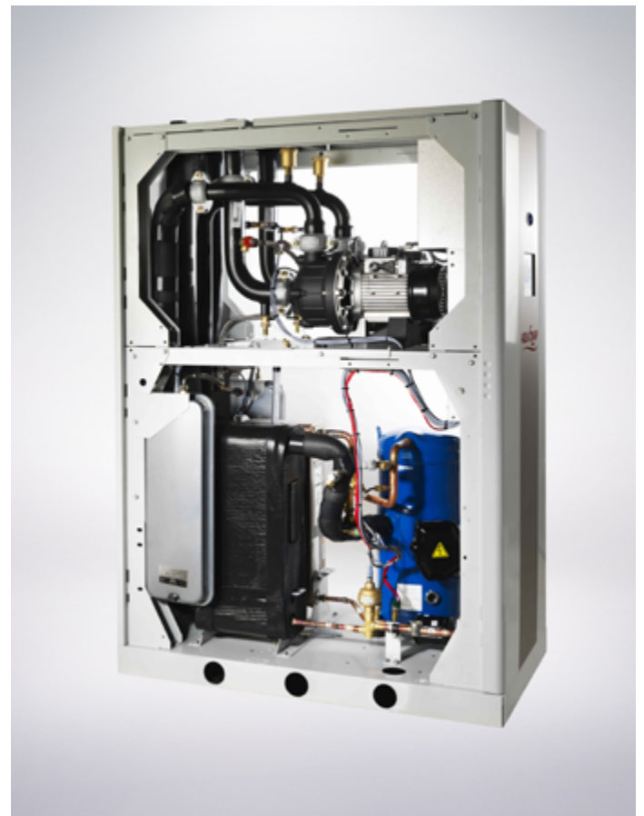
Abb. 28: Für Abwärmenutzung aus Kühlwasser geeignete Wärmepumpe (Wasser-Wasser-Wärmepumpe 61WG von Carrier, Heizleistung 29 bis 117 kW). Sichtbar sind Verdichter, Umwälzpumpe sowie Verdampfer und Verflüssiger, ausgeführt als Plattenwärmeübertrager.
