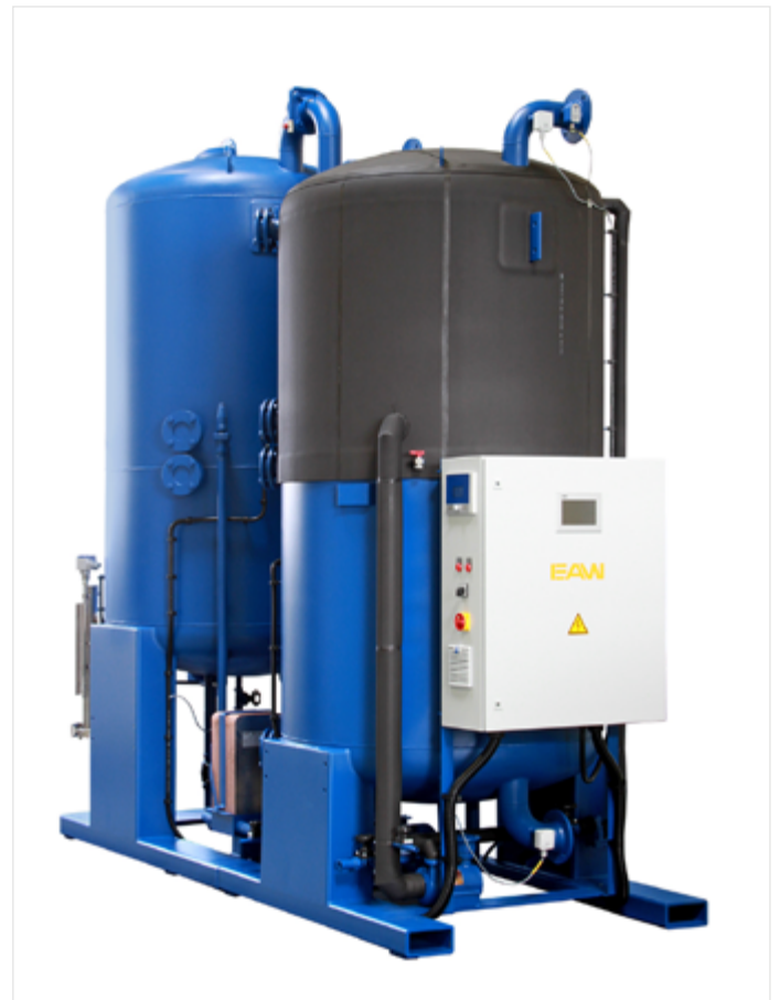
Abb. 30: Absorptionskältemaschine (WEGRACAL SE 200) mit Stoffpaarung Wasser/LiBr und 200 kW Kälteleistung (Kühlwasser bei 9 °C). Bestehend aus Verdampfer-Absorber-Einheit (vorn) und Kondensator-Austreiber-Einheit, heißwasserbetrieben (266 kW, 86 °C, \zeta=0,75 ).
