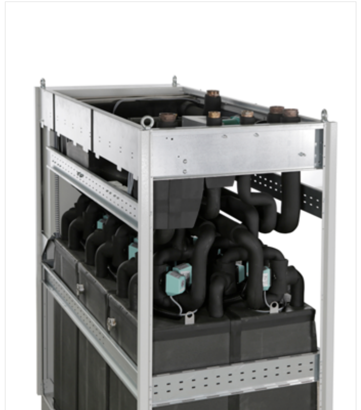
Abb. 33: Adsorptionskältemaschine auf Silikagel-Basis (eCoo Industry von SorTech), betrieben mit Heißwasser zwischen 50 und 90 °C, bis 48 kW Kälteleistung (8 bis 21 °C, \zeta = 0,65 )
