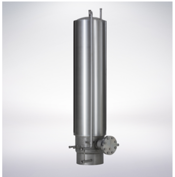
Abb. 17: Speicherprinzipien sind auch kombiniert einsetzbar: 150-l-Warmwasserspeicher (sensibel) mit innenliegendem Wärmeübertrager (Thermobatterie L-O-T), erweitert um 2-kWh-Latentwärmespeicher auf Natriumacetat-Basis in der Behälterwand (entspricht weiteren 50 Litern Wasser).
