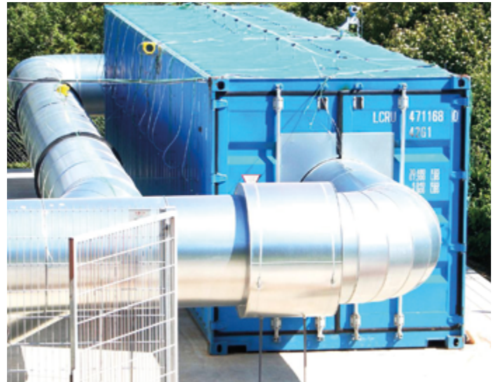
Abb. 21: Modularer Wärmespeicher mit Beton als Speichermedium
