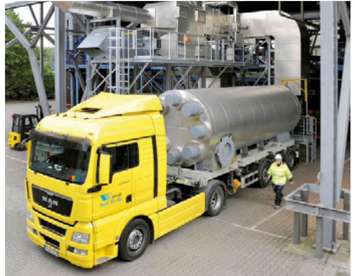
Abb. 26: Mobiler Adsorptions-Wärmespeicher
